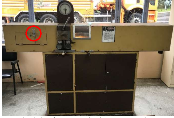
Şekil 2 Sıfır Ayar Mekanizması Damgalaması
