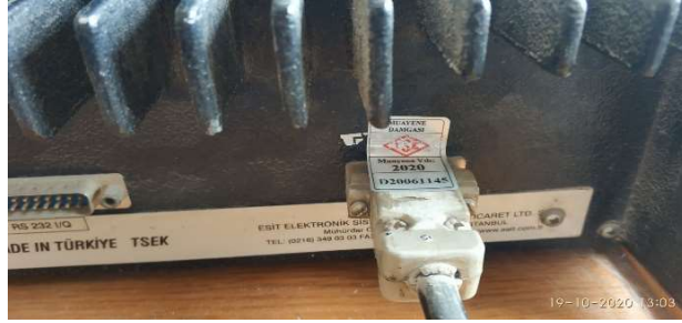
Şekil 4 Load Cell - İndikatör Bağlantısının Damgalanması
