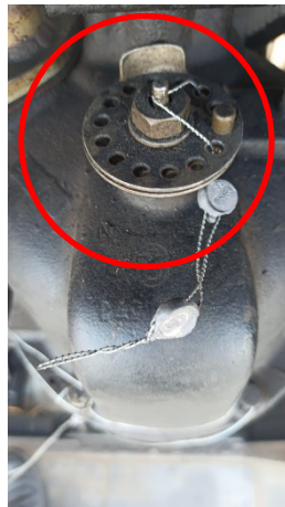
Şekil 8 Tip 3 Brodimetre Ayar Vidası Damgası
