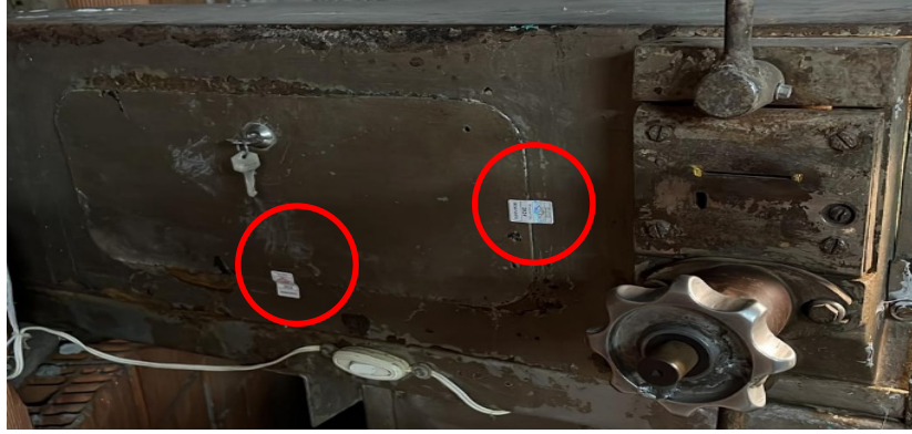
Şekil 2 Sıfır Ayar Mekanizması Örnek Damgalaması
