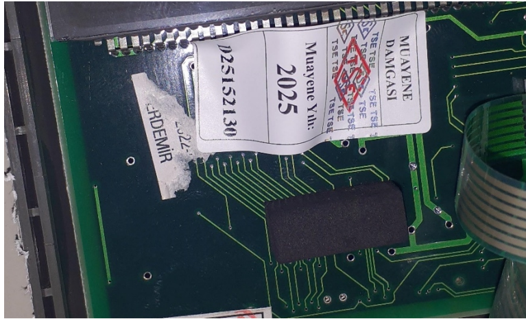
Şekil 6 Kalibrasyon Anahtarı Damgalaması (EDI800 İndikatör)
