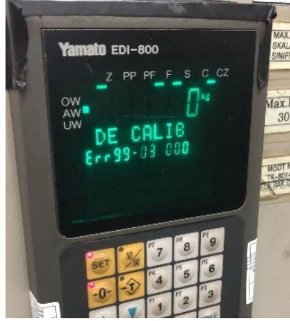
Şekil 4 Menüden Kalibrasyon Kontrolü Hata Kodu (EDI800 İndikatör)
