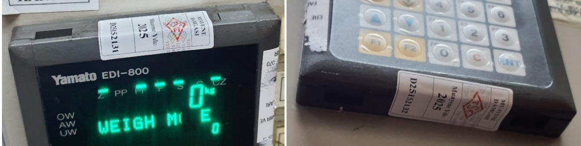
Şekil 8 EDI-800 İndikatör Ön Panel Damgalaması
