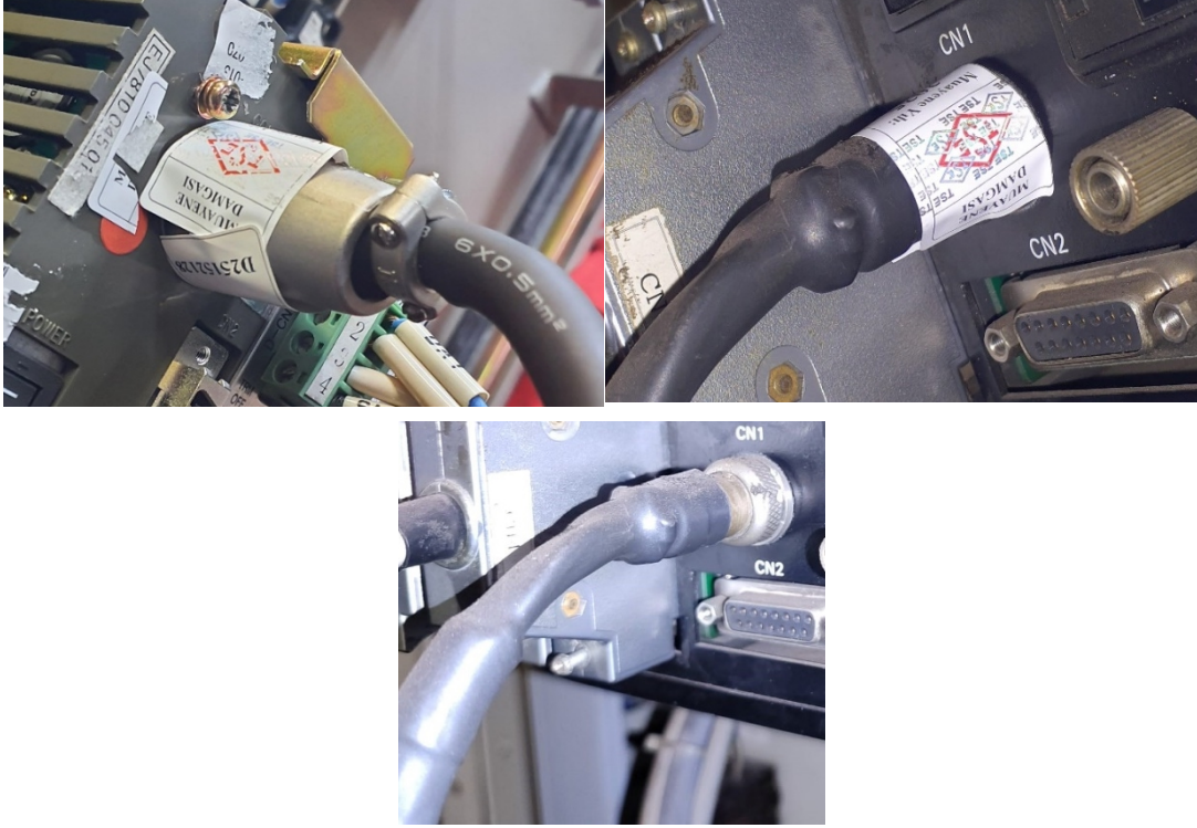
Şekil 6 EDI-700 ve EDI-800 Modellere Ait Loadcell Damgalaması
