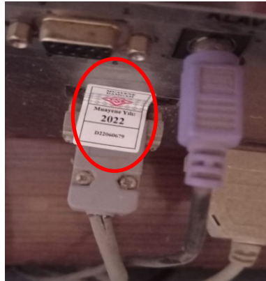
Şekil 4 Yük Hücre (Load-cell) kablosu-indikatör bağlantı damgası
