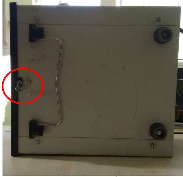
Şekil 2 Kalibrasyon Anahtarı Ve Örnek Damgalaması
