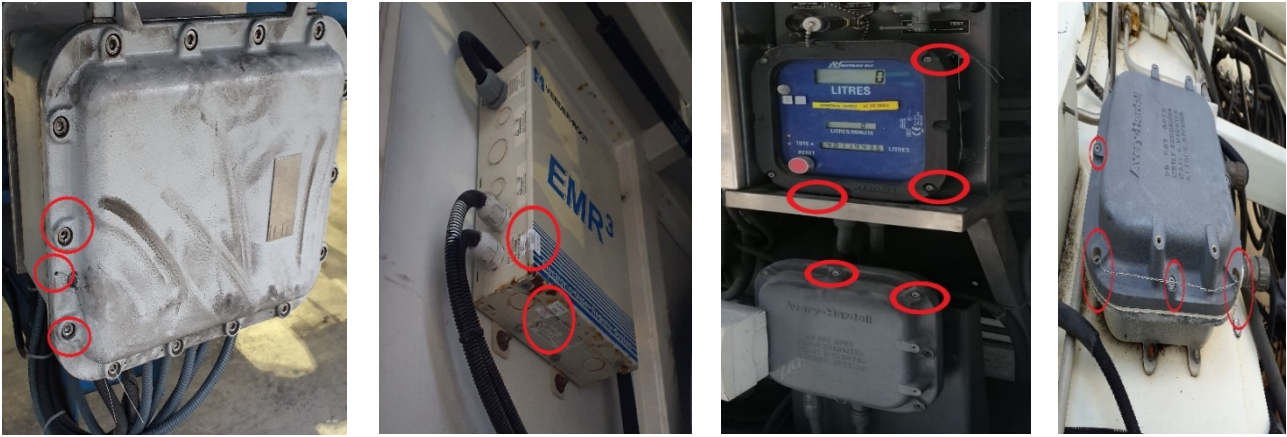
Şekil 7 Elektronik Kutusu Örnek Damgalaması
