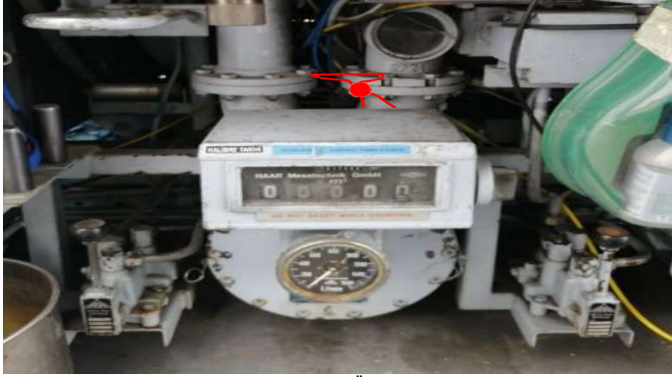
Şekil 6 Gözetleme Camı Örnek Damgalaması
