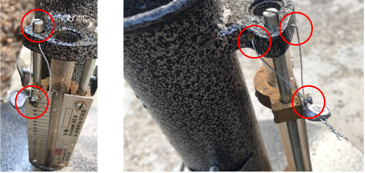
Şekil 2 Hacim Ölçek Kabı Örnek Gösterge Damgalaması
