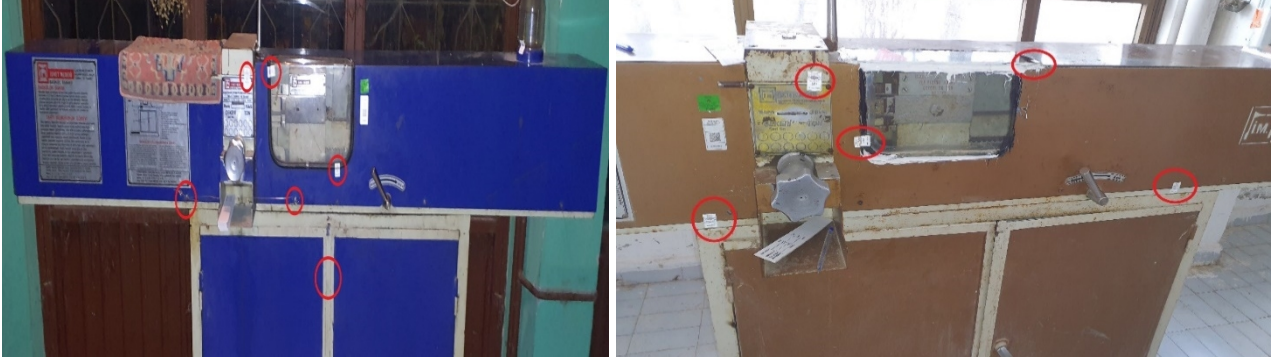
Şekil 4 Endikatör/Ayar Cetveli Damga Noktaları
