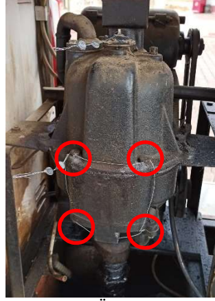
Şekil 2 Brodimetre Örneğinin Damgalanması
