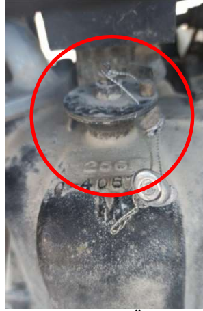
Şekil 3 Brodimetre Ayar Vidasının Damgalanması
