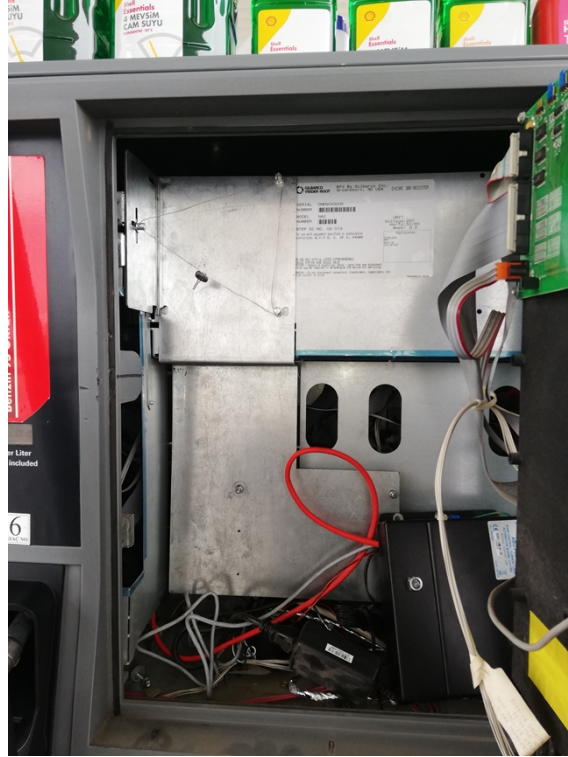
Şekil 9 Tip 4 İşlemci Ünitesi ( Beyin / CPU) Örnek Damgalaması
