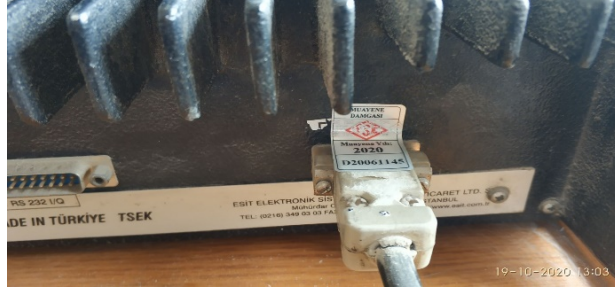
Şekil 4 Load Cell - İndikatör Bağlantısının Damgаланması
