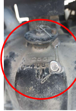
Şekil 4 Tip 1 Brodimetre Ayar Vidası
