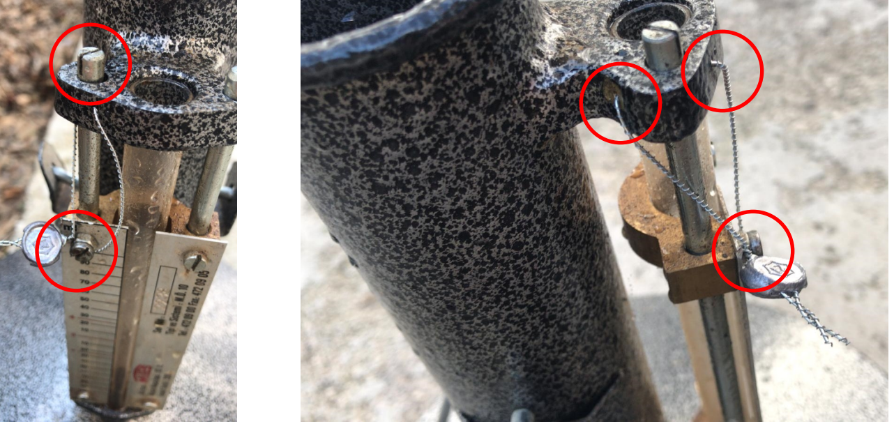
Şekil 2 Hacim Ölçek Kabı Örnek Gösterge Damgalaması
