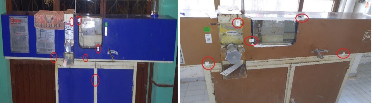
Şekil 4 Endikatör/Ayar Cetveli Damga Noktaları
