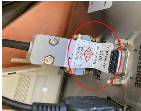
Şekil 4 Yük Hücresi Gösterge Bağlantısının Damgalanması
