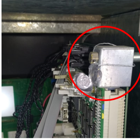
Şekil 6 İşlemci Ünitesi Örnek Damgalaması
