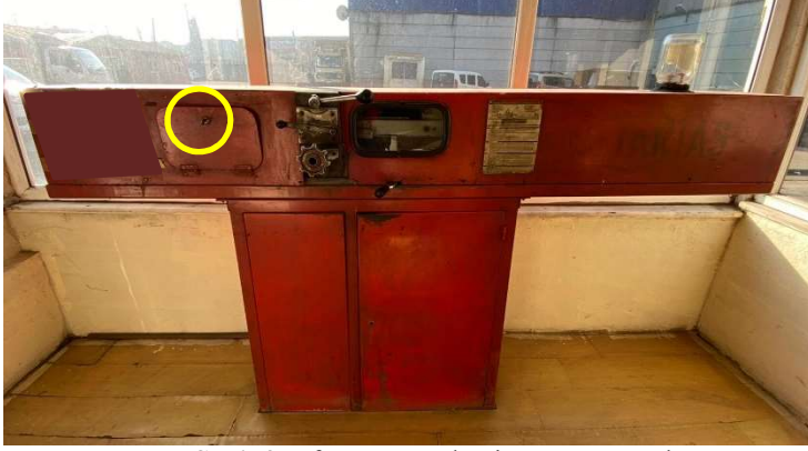
Şekil 2 Sıfır Ayar Mekanizması Damgalaması
