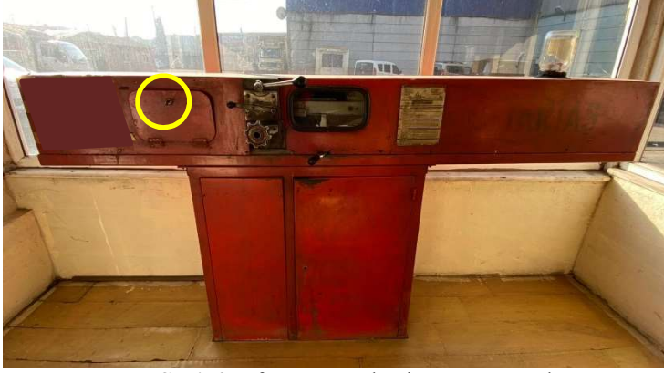
Şekil 2 Sıfır Ayar Mekanizması Damgalaması
