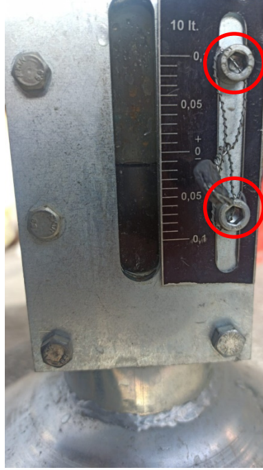
Şekil 2: Hacim Ölçek Kabı Örnek Gösterge Damgalaması
