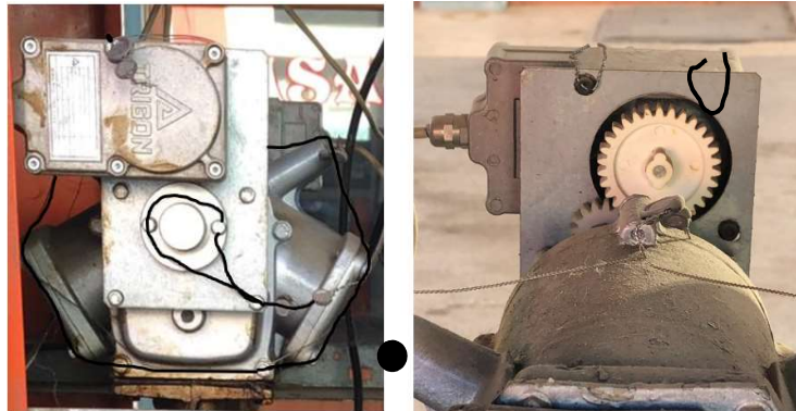
Şekil 7 Tip 2 ve Tip 3 Brodimetre Ayar Vidası Örnek Damga
