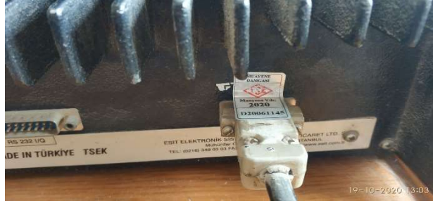
Şekil 4 Load Cell - İndikatör Bağlantısının Damgalanması
