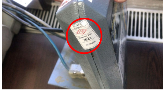
Şekil 2 İndikatör Damgası (Tel ve Kurşun Damgayla)
