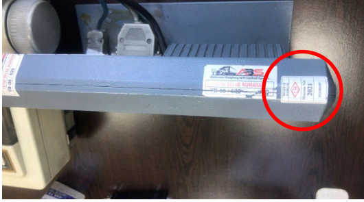
Şekil 2 İndikatör Damgası (Tel ve Kurşun Damgayla)
