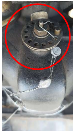
Şekil 8 Tip 3 Brodimetre Ayar Vidası Damgası
