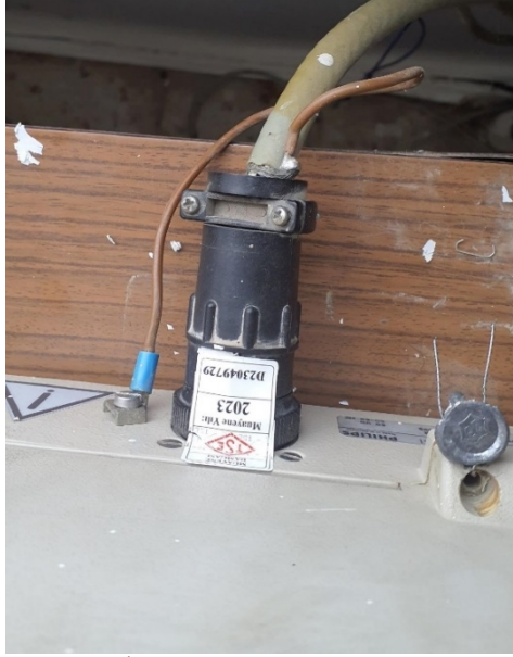
Şekil 4 Load Cell - İndikatör Bağlantısının Damgalanması
