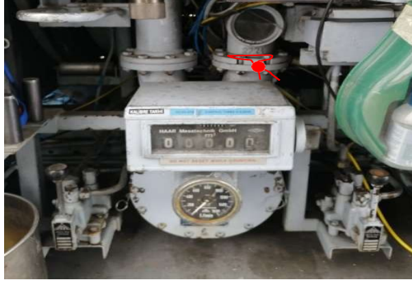
Şekil 6 Gözetleme Camı Örnek Damgalaması
