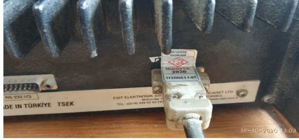
Şekil 4 Load Cell - İndikatör Bağlantısının Damgalanması
