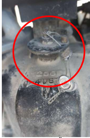
Şekil 3 Brodimetre Ayar Vidasının Damgalanması
