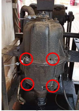
Şekil 2 Brodimetre Örneğinin Damgalanması
