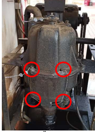
Şekil 2 Brodimetre Örneğinin Damgalanması
