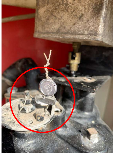
Şekil 3 Brodimetre Ayar Vidası Damgalaması
