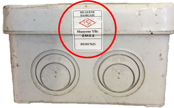
Şekil 7 Yük Hücresi (Loadcell) Soketi Damga Yeri
