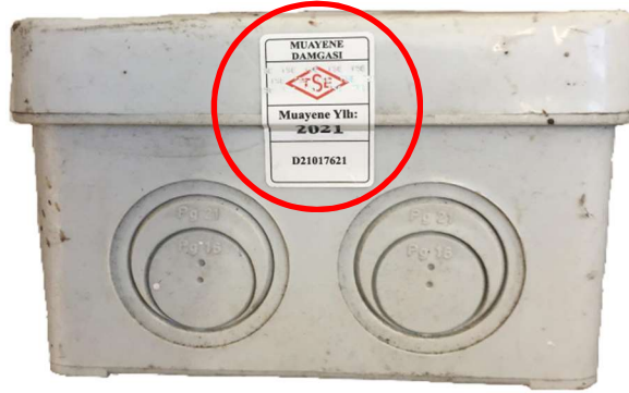
Şekil 7 Yük Hücresi (Loadcell) Soketi Damga Yeri
