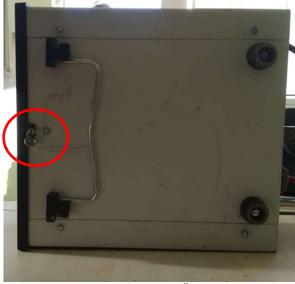
Şekil 2 Kalibrasyon Anahtarı Ve Örnek Damgalaması
