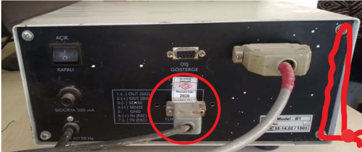
Şekil 3 Loadcell – Gösterge Bağlantısı Damgalaması ve Gösterge Arka Kapak Damgalaması
