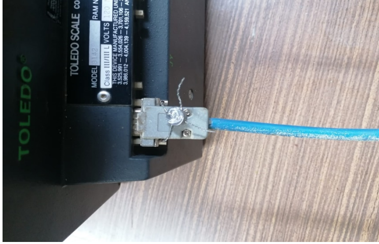
Şekil 4 Yük Hücresi Gösterge Bağlantısının Damgalaması
